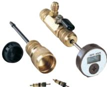
El adaptador especial de los desinstaladores/reinstaladores válvula de obús, permite reemplazar la válvula de obús estropeada sin tener que descargar el sistema. La sustitución de la válvula ya no necesitará más el largo tiempo de recuperación del refrigerante. El muy preciso cálculo de sobrecalentamiento se puede efectuar a partir de la lectura del mismo adaptador.
