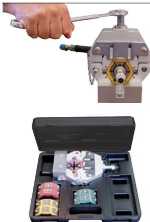
La nueva 71550 es nuestra prensa de "estilo manual" para mangueras de A/C. Los dados encajan rápidamente en su sitio sin necesidad de clavos o tornillos. La unidad puede ser montada fácilmente en un banco, usando el accesorio de fijación o sujetándola con seguridad en una prensa de banco. Este kit viene con set completo de dados que cubre los tamaños estandar # 6, # 8, # 10, y # 12.
