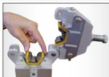
El dado encaja en la instalación de la prensa rápidamente, sin necesidad de clavos o tornillos.
