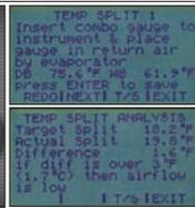
Con sólo dos medidas, el sensor dará la temperatura deseada y la temperatura actual a través del evaporador y comparará las dos.
