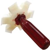
Limpia y endereza las aletas de condensador y evaporizador. Cabeza con seis peines para 8, 9, 10, 12, 14 y 15 aletas por pulgada de aplicación.
