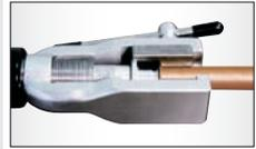
El tubo de cobre es asegurado en la instalación de fijación por la conformación de los dados. La bomba empuja el adaptador hacia adentro para abocinar o expandir. Este recuadro muestra la formación en proceso.
