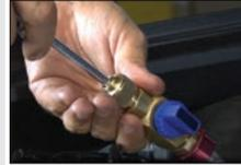
**DESINSTALADOR DE VÁLVULA DE OBÚS**
