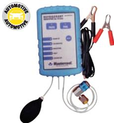
El Identificador de Refrigerante ayuda a confirmar la presencia de refrigerante R134a en el sistema de aire acondicionado de un vehículo. Este proceso ayudará a eliminar daños potenciales causados por refrigerantes contaminados. Esta unidad entrega un análisis rápido y preciso en un equipo sólido, compacto y portátil. Este identificador de refrigerante entrega paso a paso y en forma automática todo el proceso de la toma del ejemplo del gas.
