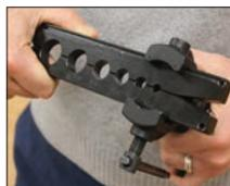
El riel permite que el puente se mueva suavemente mientras el abocinador y la barra se mantienen alineados.
