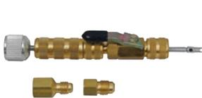
**Para refrigerantes de alta presión (410A)** Nuevamente diseñado con mecanismo de fijación patentado, el 91498 es el único kit desinstalador de válvula de obús, que tiene una tuerca de seguridad que permite al técnico el libre acceso a la válvula de obús sin tener que luchar con altas presiones. Empacado en un moldeado estuche para transporte, este kit también ofrece 1/2"-20 UNF Y 1/4" conectores para el uso de todos los refrigerantes.
